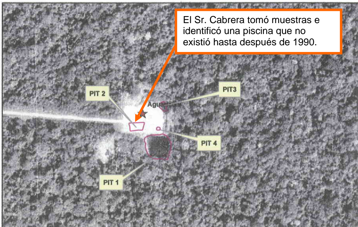
Figura 6.1 Fotografía aérea del pozo Aguarico 9, donde el Sr. Cabrera identificó y tomó muestras de una piscina que no existió hasta después del 1990. Al examinar las fotografías de buena calidad con estereoscopio, no hay indicio alguno de que hubiera una piscina en este lugar hasta el año 2000. La Piscina 3 del Sr. Cabrera parece estar conformada por sombras de árboles.
