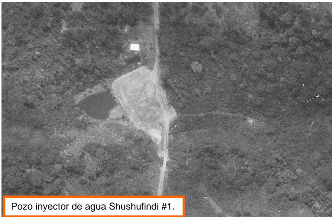
Figura 7.2 Fotografía aérea del pozo inyector de agua Shushufindi #1. Éste es claramente el mismo pozo que el que se observa en la Figura 7.1.
